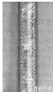
Aタイプ 立向上進溶接
