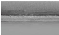
電気亜鉛めっき鋼板
