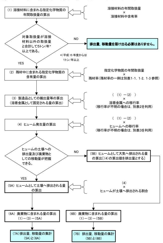
溶接材料残材率(%)算出条件被覆アーク溶接棒12.5~14棒長350~400mmで残材を50mmとして計算フラックス入りワイヤ<br/>及びソリッドワイヤく0.0151.2mm φ x200~350kgで残材を3mとして計算及びソリッドワイヤ0.15~0.21.2mm φ x12.5~20kgで残材を3mとして計算ティグ溶接用溶加棒5~10棒長1000mmで残材を50~100mmとして計算
